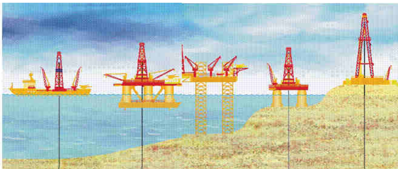
Рисунок 2.3 – Виды буровых установок и платформ
